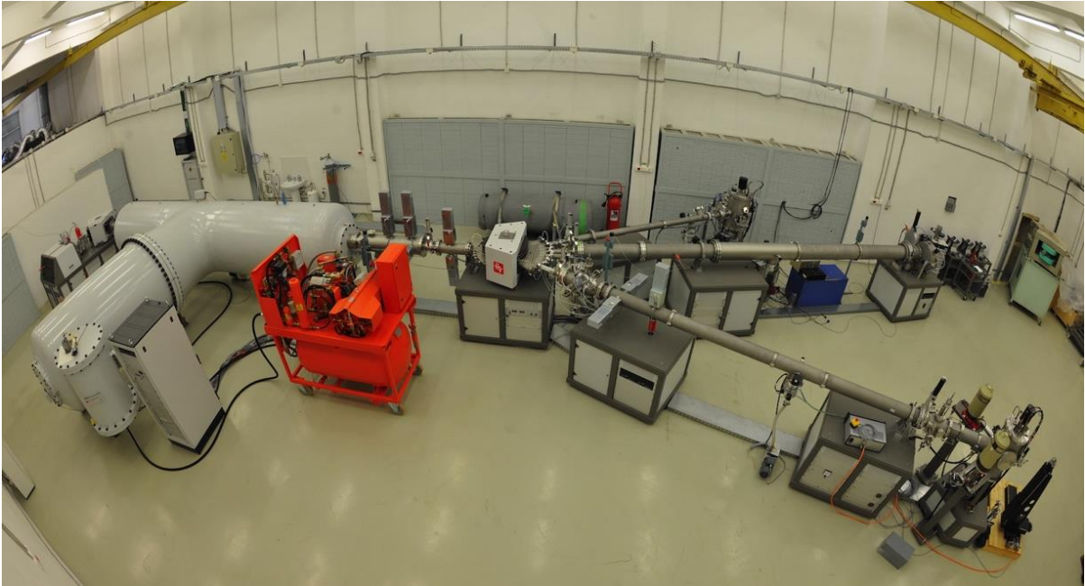
Acceleratorul de tip HVE Tandron de 3 MV
