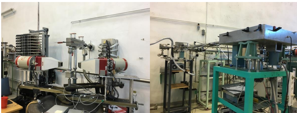
Sistemul de transport al radioactivității pentru experimente de dezintegrare beta în fond redus.
