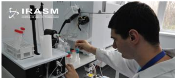
Analize ICP-MS: detectie de urme (ppb/ppt) si amprenta elementala
