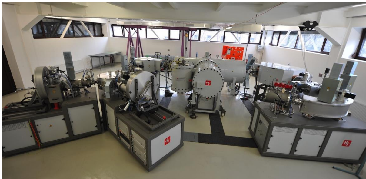
Acceleratorul Tandetron de 1 MV dedicat spectrometriei de masă cu acceleratori
