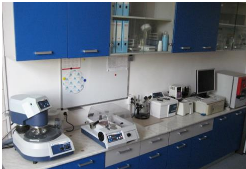
Echipamentele de tăiere, șlefuire și pregătire a probelor în vederea analizării cu microscopul de forta atomica
