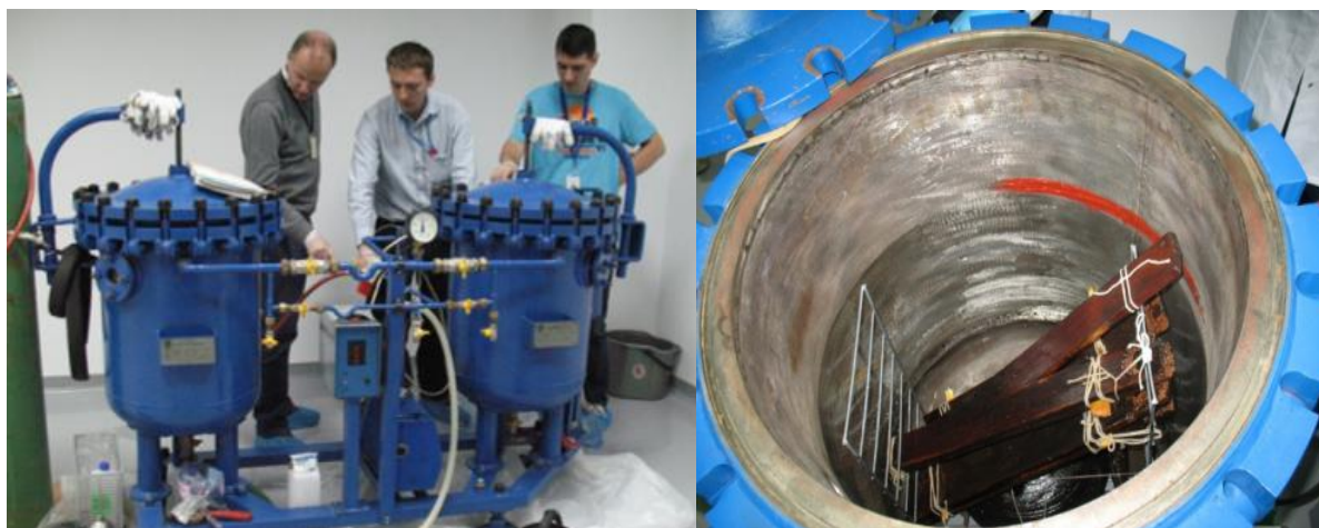
Infrastructura pentru demonstrarea de tehnologii de consolidare prin impregnare si radiopolimerizare
